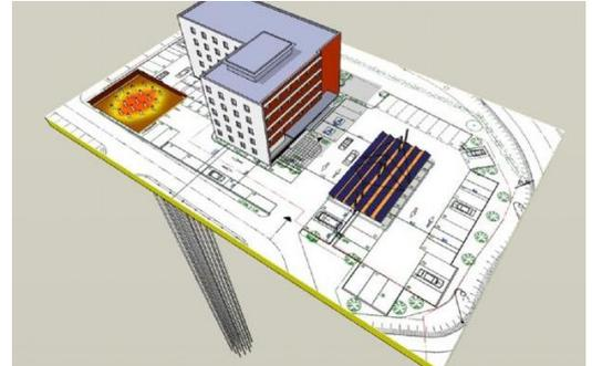
Les puissances ce type de système peuvent aller de 50 kW à 4 MW selon le diamètre et la profondeur de l'installation. Par exemple, une installation de 32m de rayon (3 200 m<sup>2</sup>) à 30m de profondeur pourra stocker environ 3 000 MWh et restituer 2MW soit les besoins de chauffage de 32 000 m<sup>2</sup> de logements.<sup>49</sup>
